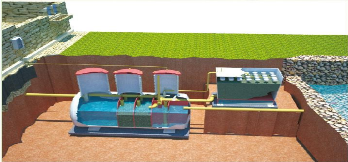
Hình 3.1. Sơ đồ cấu tạo bể XLNT hợp khối bằng vật liệu Composite
